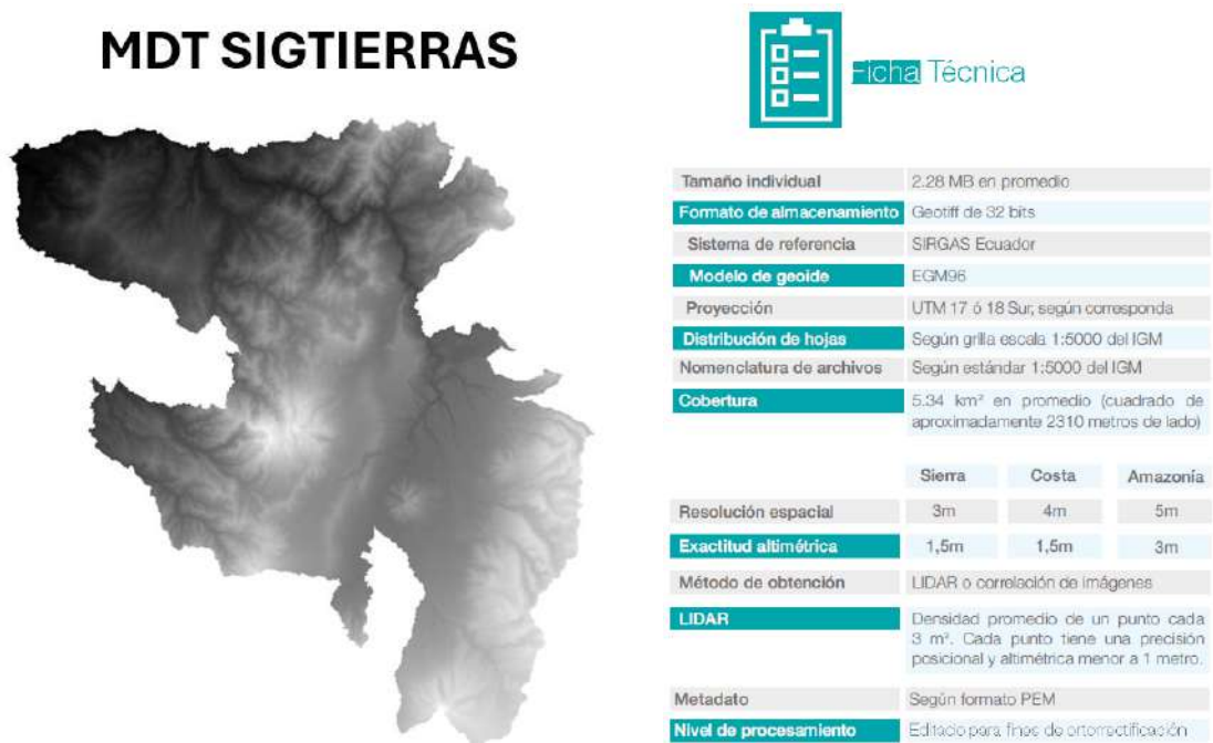
Figura 2. Modelo Digital de Terreno (MDT-SIGTIERRAS) del DMQ y su ficha técnica general
